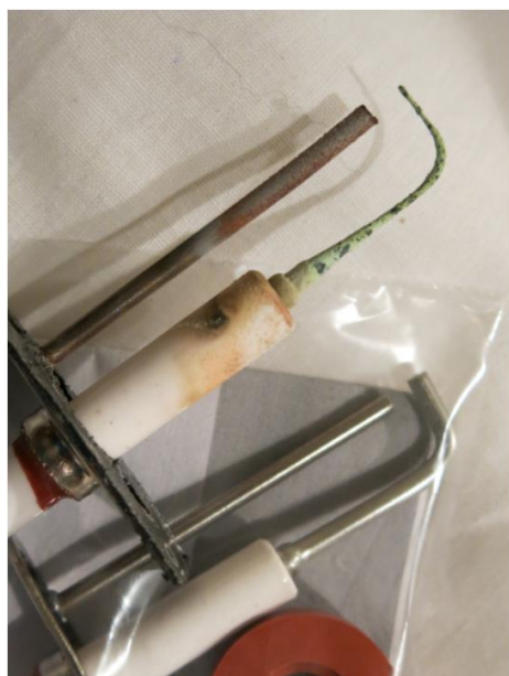
De ontstekers, nieuw en na een jaar en 8000 m 3 gas.
