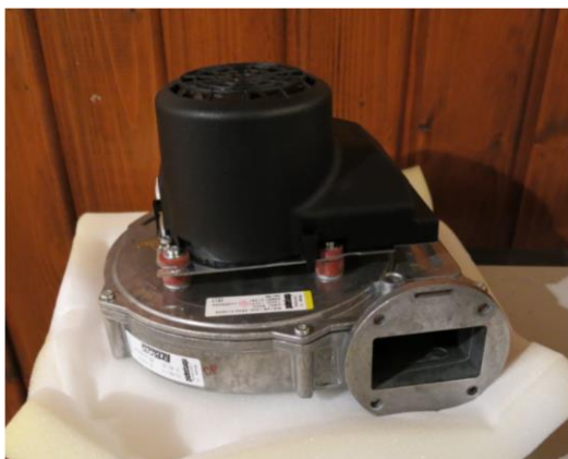
Foto hierboven: de vervangen ventilator-unit
